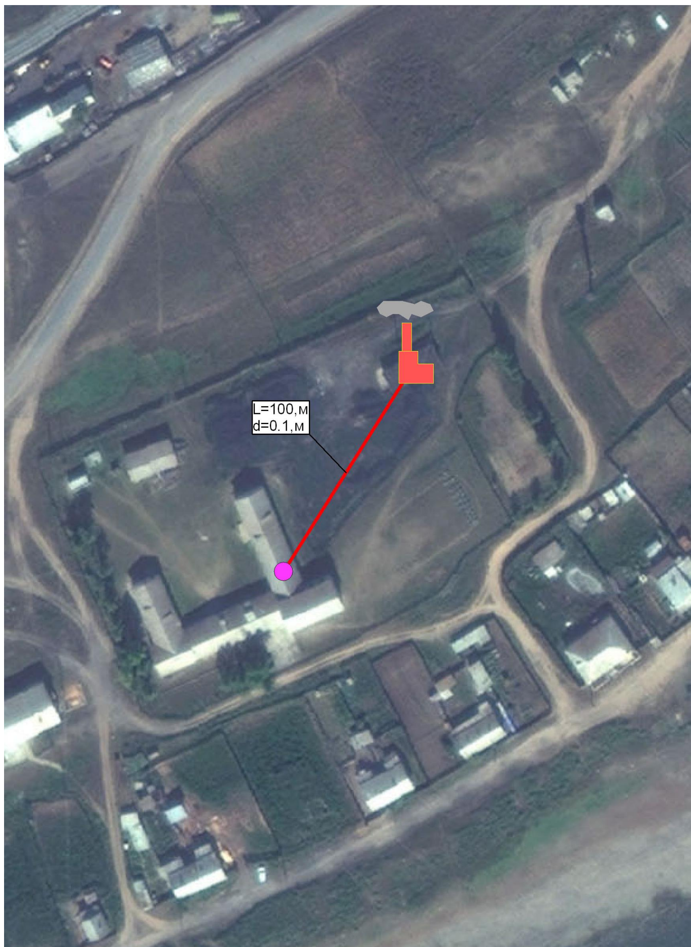
Рис. 2.12 – Схема теплоснабжения муниципального образования городского поселения "Сретенское" от котельной МОУ "Матаканская ООШ"
