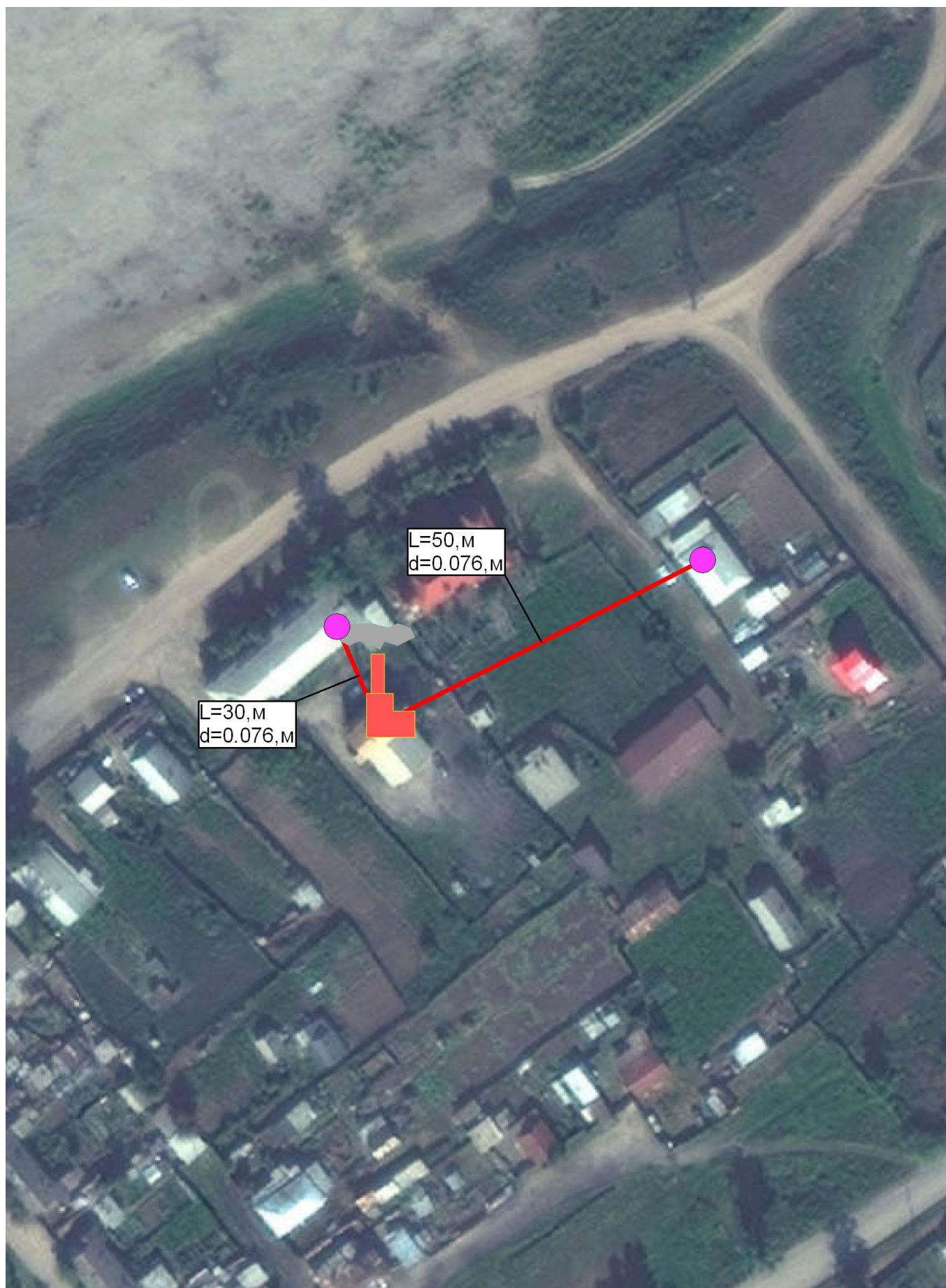
Рис. 2.13 – Схема теплоснабжения муниципального образования городского поселения "Сретенское" от котельной МУП Редакции газеты "Советское Забайкалье"
