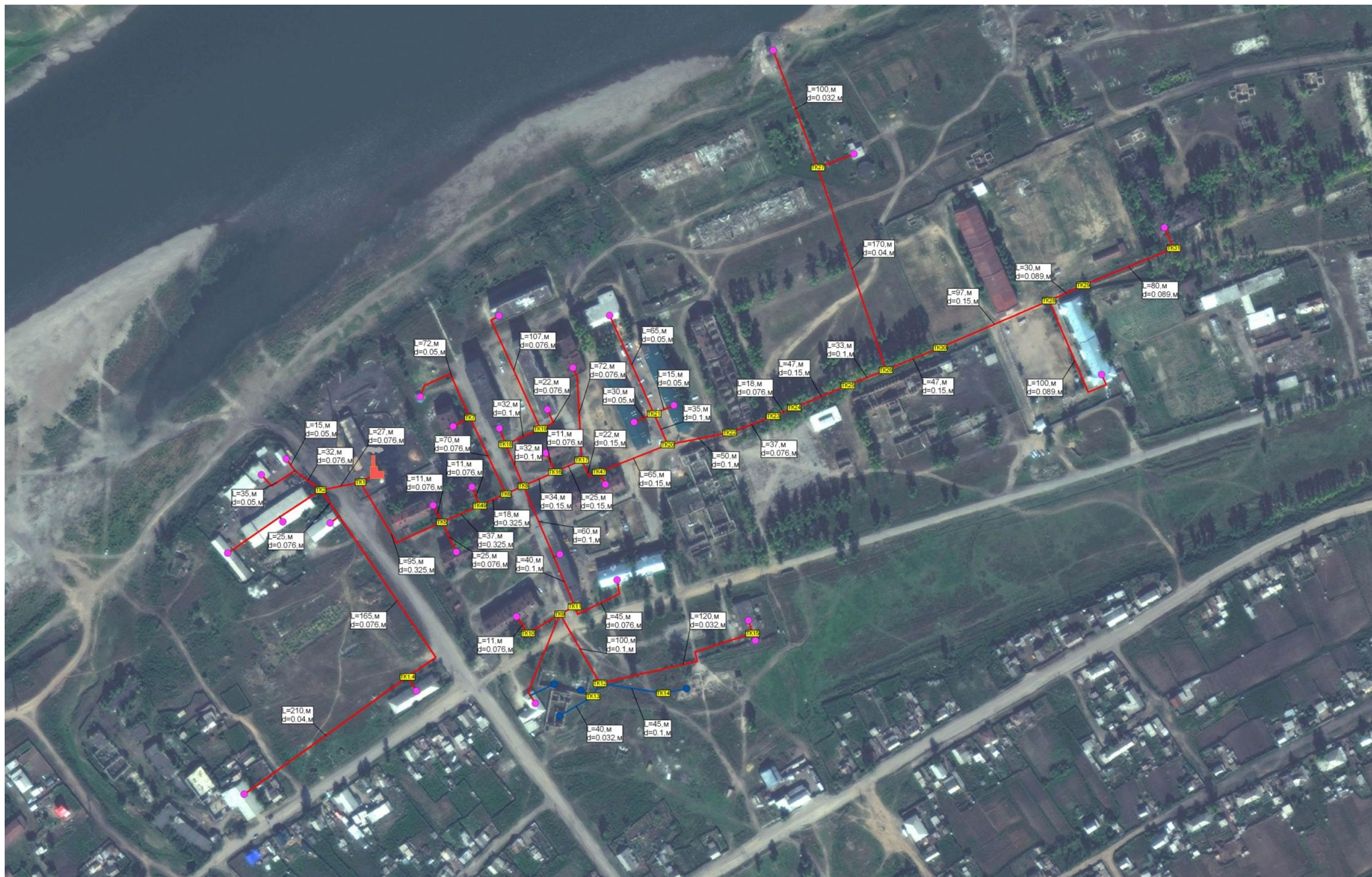
Рис. 2.2 – Схема теплоснабжения муниципального образования городского поселения "Сретенское" от котельной №1
