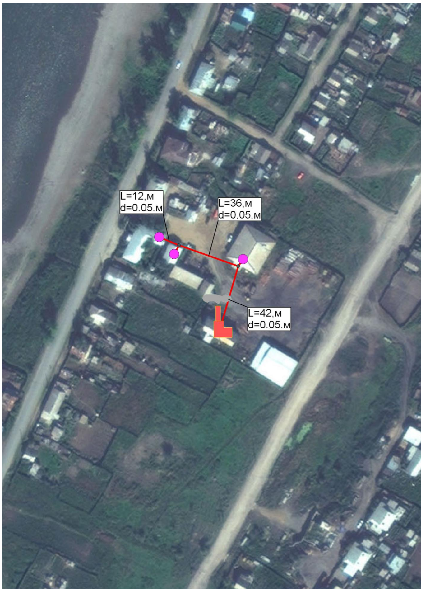
Рис. 2.7 – Схема теплоснабжения муниципального образования городского поселения "Сретенское" от котельной КГУ "Сретенский лес"
