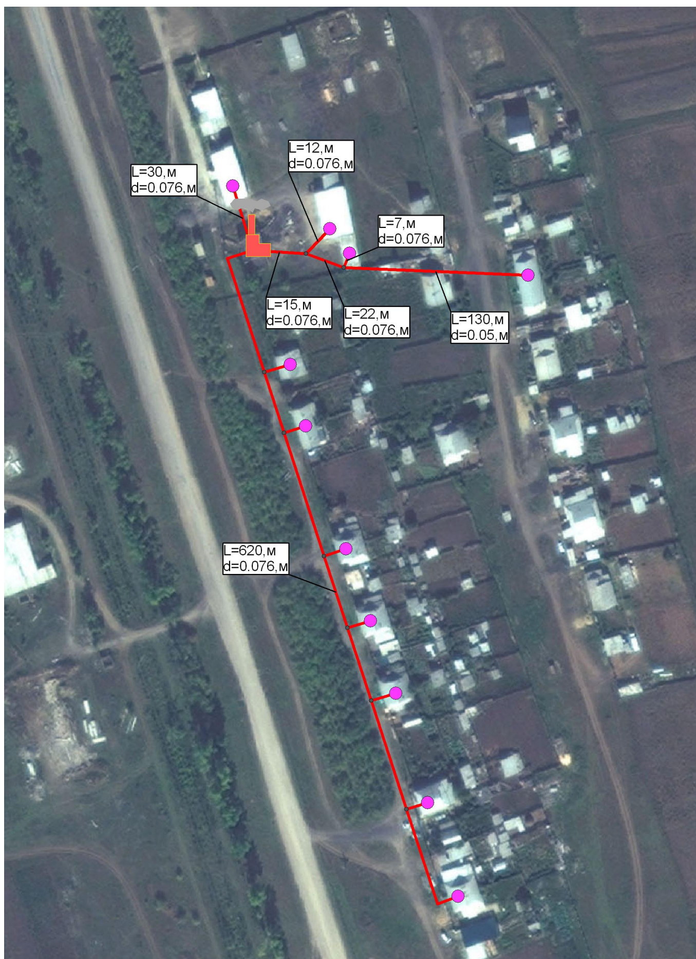
Рис. 2.6 – Схема теплоснабжения муниципального образования городского поселения "Сретенское" от котельной №6
