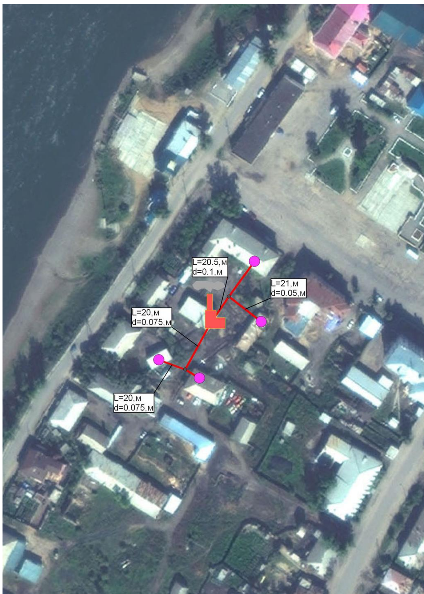
Рис. 2.3 – Схема теплоснабжения муниципального образования городского поселения "Сретенское" от котельной №2
